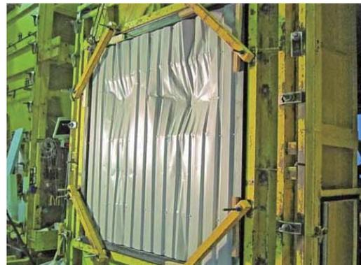
写真6 飛来物耐衝撃性試験の例
