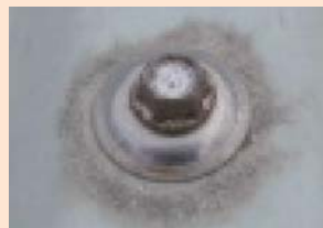
ステンレス(SUS430)製ボルトによる フッ素塗装55%Al-Znめっき鋼板
