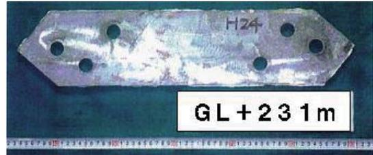
写真4 塗膜除去後の鋼材表面状況
