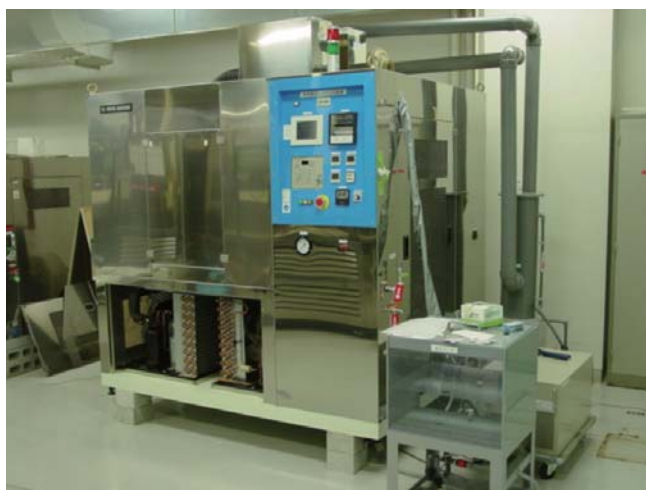
図12 耐候性・耐食性複合サイクル試験機
