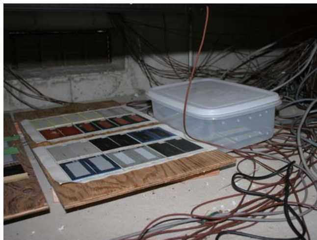
図11 住宅内暴露試験状況
