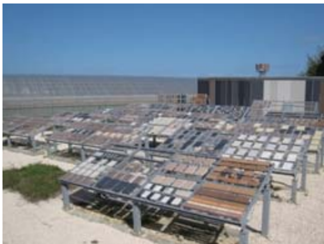
図8 屋外暴露試験状況
