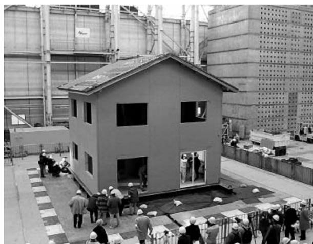
写真1 実大振動台実験
