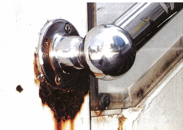
ステンレスと鉄の組合せによる接触腐食例
