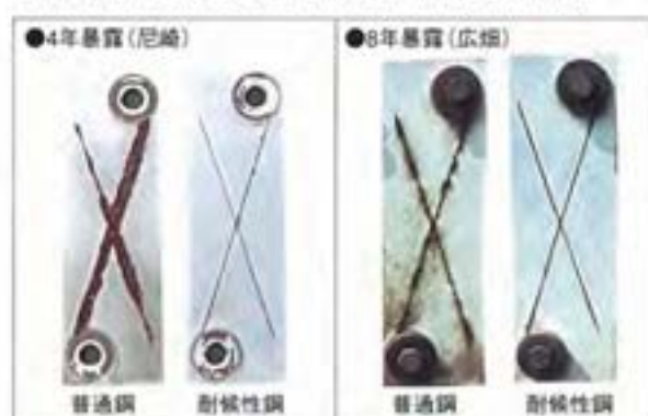
■耐候性鋼と普通鋼の塗装材の暴露比較試験結果
