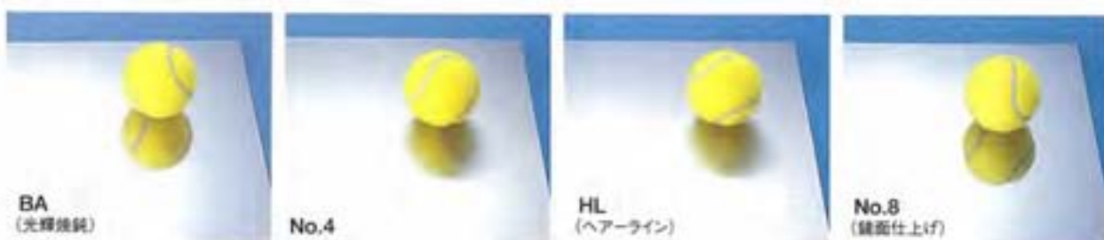
■ステンレス鋼の表面仕上げ例
