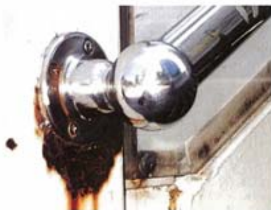
ステンレスと鉄の組合せによる接触腐食例
