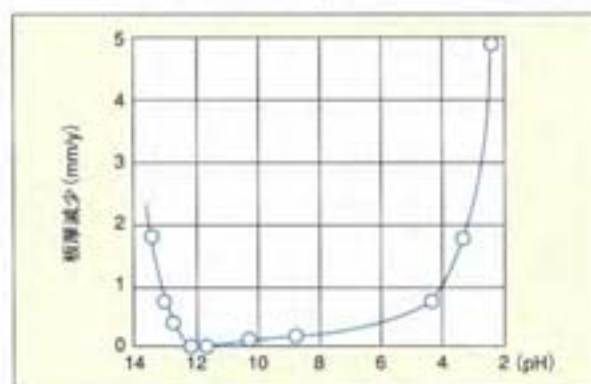
■亜鉛の腐食に及ぼす溶液のpHの影響
