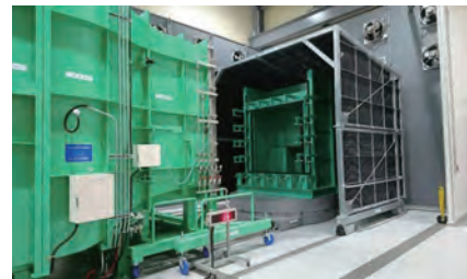
写真2 「送風散水試験」装置 試験体設置側
