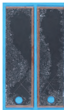
写真7-2 端面塗膜の膨れおよび白錆例
